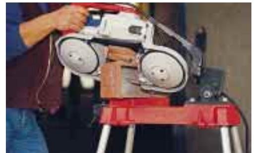
**Milwaukee-Bandsäge mit Bimetall-Sägebändern und stufenlos einstellbarer Sägeschwindigkeit und einer Schnittleistung von 121 mm**
