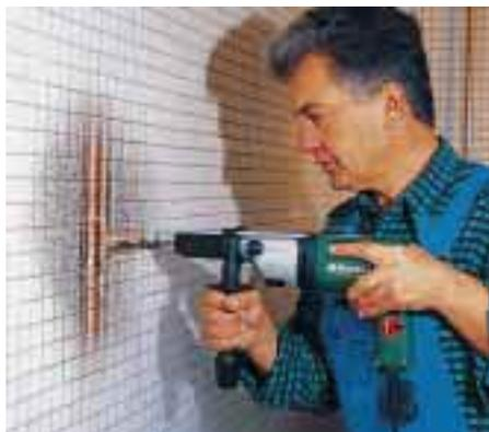
**Die abschaltbare Contact-Funktion stoppt die Maschine, wenn sie auf leitendes, geerdetes Material oder eine stromführende Leitung trifft**
