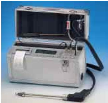
*Bei Schwankungen der Gaskonzentration schaltet das IMR 1400 PD selbständig zwischen den zwei CO-Sensoren um*
