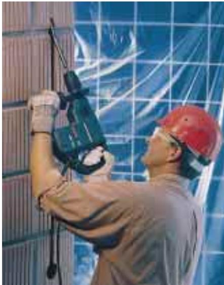
Beim Bosch-Bohrhammer GBH 4 DFE mit Vario-Lock kann der Meißel in 36 Positionen fixiert werden
