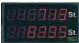
ware für Datensicherung und Grenzwert-überwachung auch mehrerer vernetzter An-zeigen. Während die GA-100 im schwarz-zen, 300 × 166 × 35 mm großen Alugehäu-se einen Meßwert mit vier Stellen in 57 mm Ziffernhöhe anzeigt, signalisiert die GA-200 zwei sechsstellige Werte mit 45 mm hohen Ziffern. Inklusive Meßtechnik, Soft-ware und Wandhalterung gibt's die GA-100 ab 1100 DM.
