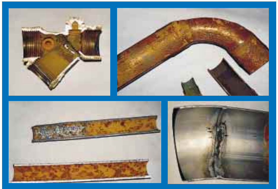
Kein metallischer Werkstoff für Trinkwasseranlagen scheint gegen Korrosion gefeit, sei es Messing (o. l.), Kupfer (o. r.), verzinkter Stahl (u. l.) oder Edelstahl
