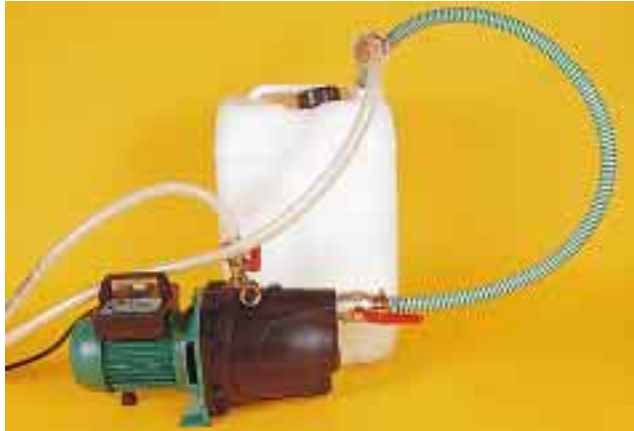
Bild 3 Nach seiner Entnahme aus dem Solarkreis kann der Wärmeträger per Frostschutzprüfer auf Frostfreiheit überprüft werden (Bild: Wagner & Co., 35091 Cölbe)
