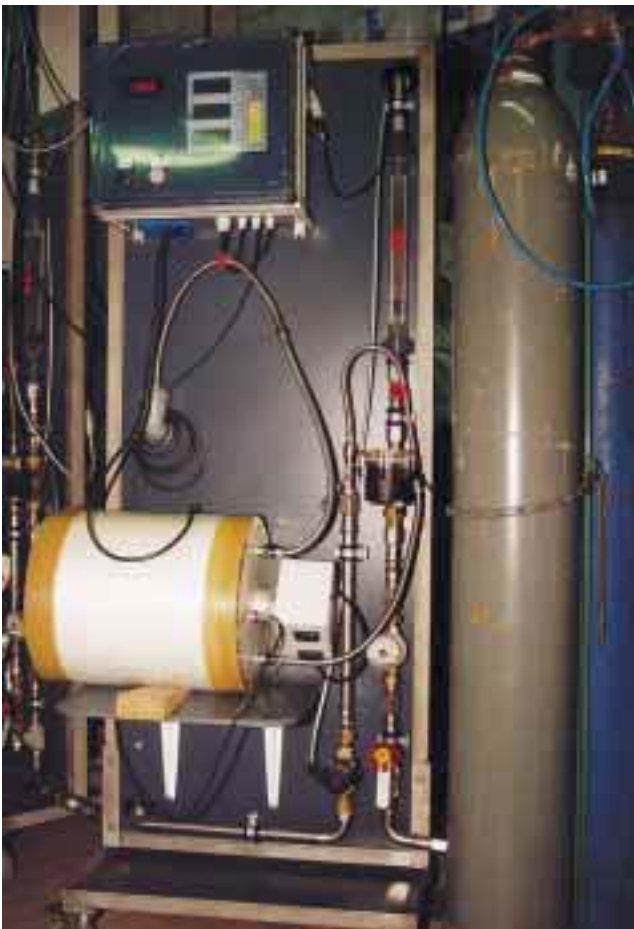
W 512 in der Praxis: Als Trinkwassererwärmungsanlagen dienen fabrikmäßig hergestellte, drucklose und elektrisch bis 80 °C beheizbare 10-Liter-Speicher aus nichtrostendem Stahl
