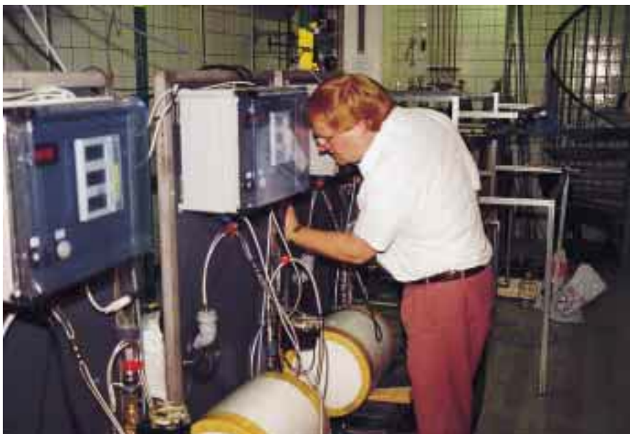
Nach den ersten 21 Tagen reinigten die Tester die Apparatur und schalteten um. Die zwei Blindstrecken wurden zu aktiven Strecken und die beiden ehemals aktiven zu Blindstrecken
