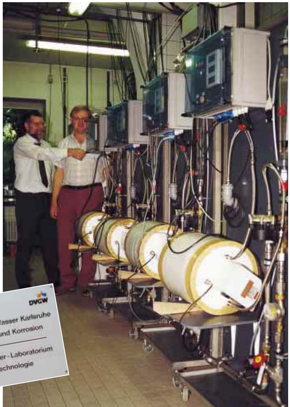
Dr. Ivo Wagner (l.) und Prüfer Schmidt am Prüfstand. Während der Versuche sind zwei der vier Teststrecken mit den zu prüfenden Anlagen bestückt. Die zwei anderen dienen als Blindstrecke zum Vergleich
