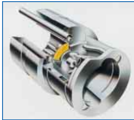
Kernstück des „RotriX-EV“-Ölbrenners (18, 22, 27 kW) von Viessmann ist der Brennerkopf, bestehend aus zwei längsgeteilten, achssymmetrisch angeordneten Kegelhälften
