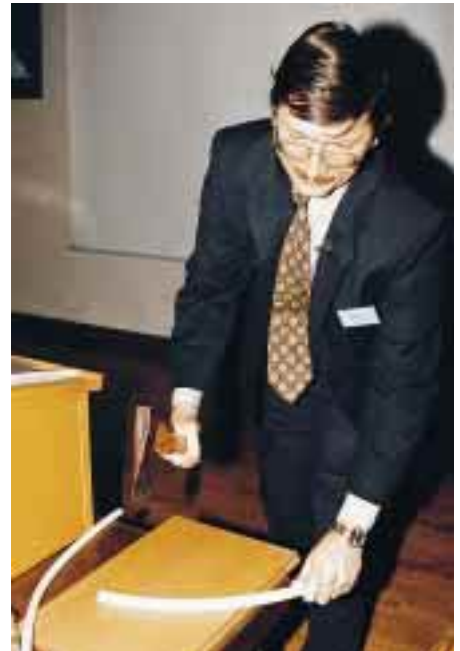
Auf „einschneidende“ Art demonstrierte Ehrenfried Bonhag die mechanische Widerstandsfähigkeit von vernetztem Polyethylen
