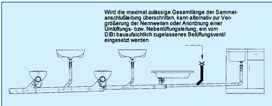
Einsatzmöglichkeit eines bauaufsichtlich zugelassenes Belüftungsventil bei einer längeren Sammelanschlusleitung
