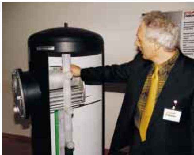
Blick in den „SolarMax“, einer intelligenten Kombination aus Gas-Brennwertgerät (mit Gebläsebrenner 5–15 kW) und Solarspeicher mit Schichtenlader
