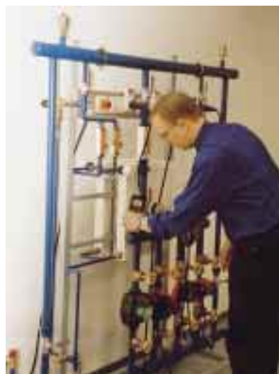
Mobiler Demonstrationsstand des FVSHK Hessen zum Thema Heizungsumwälzpumpen
