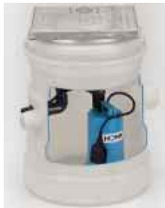
schiedene Modelle mit Motoren von 0,25 und 1,1 kW lieferbar. Die Pumpenmotoren sind mantelumflutet und so bei jedem Wasserstand gekühlt. Die Motorengehäuse bestehen aus rostfreiem Edelstahl. Auf Wunsch ist die Hebeanlage mit Pumpen bis zu 65 mm Durchgang für Wasser mit groben Schmutzanteilen, auch in explosionsgeschützter Ausführung lieferbar.
