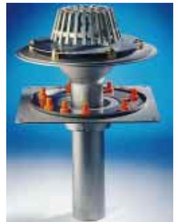
Die Folgeschäden aufgrund durchfeuchteter Isolierungen sind meist erheblich. Daher wurde der Ablauf vom Typ UNO zur Trennung der Verantwortungsbereiche Installateur und Dachdecker entwickelt. Er benötigt keine Rückstausicherung im herkömmlichen Sinne. Dämmstärken von 70–170 mm können problemlos überbrückt werden.
