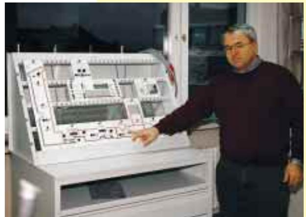
Originalregelungen und -bauteile so geändert, daß sie im Niederspannungsbereich mit 24/40 Volt betrieben werden können und beliebig kombinierbar sind. Modellmodule von Pumpen, Kesseln, Boilern, Mischern usw. werden so praxisingerecht elektroseitig angeschlossen und trocken (ohne Wasserkreislauf) in Betrieb genommen. Der Aufbau von komplexen Systemen, z. B. einer Heizungsanlage mit Solartechnik, ist damit optisch übersichtlich und gefahrlos möglich.
