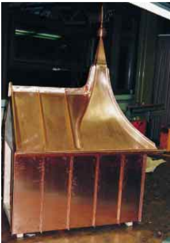
Verlangt war, daß die Winkelfalze der Seitenbekleidung mit den Doppelstehfalzen des Satteldaches eine durchgehende Linie bilden
