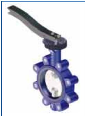
Die gekammerte Dicht-Manschette wird wahlweise in EPDM oder NBR ausgeführt. Einsetzbar sind die ARI-Klappen bis max. +130 °C (EPDM-Manschette) bzw. bis max. +80 °C (NBR-Manschette).
