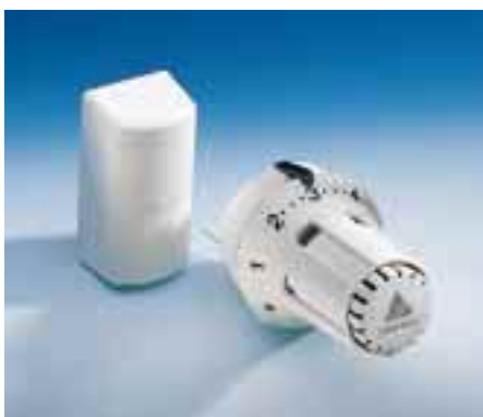
Bild 2 Thermostatkopf mit Fernfühler, wenn die Temperaturmessung am Heizkörper ungeeignet ist und an einer anderen Stelle die im Raum maßgebliche Temperatur heranzuziehen ist
