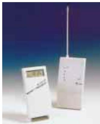
läßt sich die Raumtemperatur gradgenau an das Komfortempfinden der Kunden anpassen. Der batteriebetriebene Sender ist im Wohnbereich fest installierbar oder mobil mit einem Tischaufsteller zu benutzen. Die Empfangsstation wird mit 230 V Netzspannung an der Heizungszentrale versorgt.
