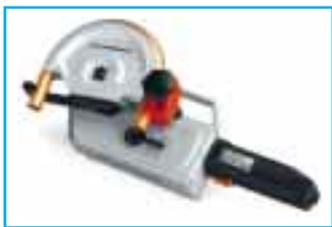
Eine automatische Endabschaltung gewährleistet den sofortigen und punktgenauen Stopp des Biegevorgangs beim Erreichen des eingestellten Biege winkels. Der Biegevorgang ist jedoch auch manuell steuerbar. Herzstück ist ein voll kugelgelagertes und stark untersetztes Power-Getriebe. Durch die Reduzierung von 32 000 auf nur 3 Umdrehungen pro Minute gewährleistet es ein hohes Übertragungsmoment für konstante Kraftübertragung.
