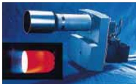
Die Luftdüse mit Dralling verbessert die Durchmischung von Öl und Luft, stabilisiert die ohne Flammenhalter und erzeugt den nötigen Unterdruck, so daß über die Rezirkulationsöffnungen genügend Abgase einströmen. Die Kombination dieser Effekte bewirkt eine blaubrennende, also kühle und stickoxidarme Flamme, die wesentlich dazu beiträgt, die Umwelt zu entlasten. Die neuen Units mit
