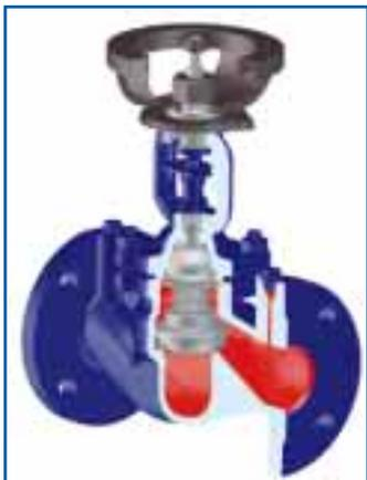
Der Metall-Faltenbalg bietet zuverlässige Dichtheit auch unter anspruchsvollen Bedingungen (entspr. TA-Luft). Der Einsatzbereich liegt standardmäßig bei max. +175 °C, ist auf Wunsch aber auch für einen Einsatzbereich bis +350 °C verfügbar.
