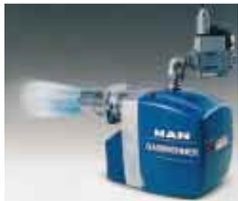
bedingungen nach DIN 4788 EN 676 gemessen wurden. Er erreicht Nox-Werte deutlich unter 70 mg/kW durch ein verändertes Mischsystem, das den Gas- und Luftstrom teilt. Der CO-Ausstoß liegt unterhalb von 10 mg/kWh. Ein zusätzliches Plus bietet der Brenner durch das optimierte Gehäuse. Damit konnte das Betriebsgeräusch deutlich gemindert werden.
