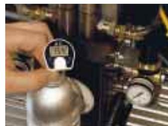
wertes gedacht, die Auto off-Funktion spart Energie, denn das Gerät schaltet sich nach 10 Minuten automatisch aus. Einsetzen läßt sich das Gerät, wo schnell die Temperatur in flüssigen, weichen oder pulverigen Stoffen gemessen werden muß. Es paßt in jede Jackentasche und ist immer griffbereit.
