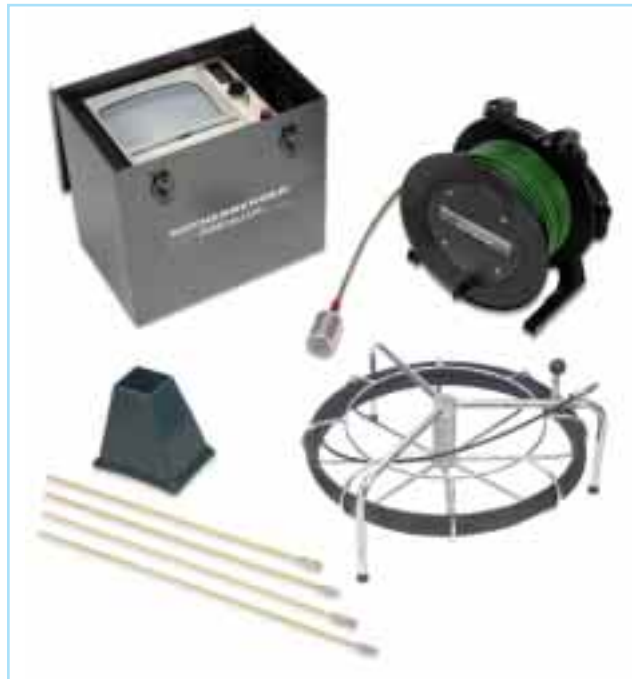
Rohre ab DN 60 lassen sich mittels tragbarer TV-Inspektionssysteme auf ihren Zustand untersuchen. Dazu gehören z. B. Monitor (o.I.), Kamerakopf mit Kabel (o.r.), Lichtschutztubus für den Monitor (M.I.), Glasfaserschiebestangen zum Nachschieben (u.I.) und Röhrenschlange auf Haspel (u.r.)
