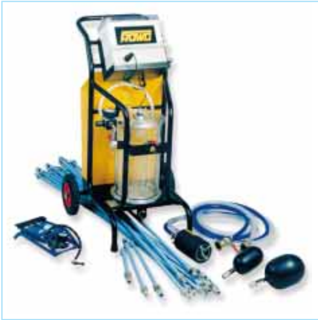
Zum Prüfen der Wasserdichtheit von Rohren und Kanälen dient das fahrbare Prüfgerät mit elektronischer Auswertung. Absperrblasen (u.r.), die über Luftschläuche und Fußluftpumpe (u.l.) aufgeblasen werden, verschließen die Leitung
