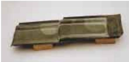
**Die alte Turmdachbekleidung bestand aus dachziegelähnlichen Blechprofilen 180 × 95, die übereinandergelegt – zu Undichtigkeiten führten**
