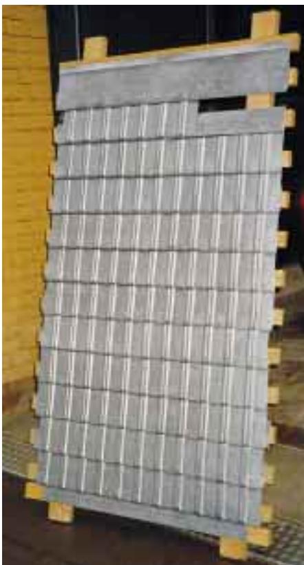
**Versuchsfläche mit Paneelbändern in Falzziegelstruktur. Das unvollständige Band (o.) verdeutlicht die Befestigung per Haftstreifen**
