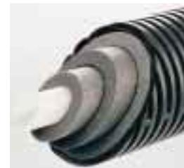
Das flexible Ecoflex-Thermo-Rohr besteht aus drei Teilen: PEX-Innenrohr, PEX-Schaumstoffdämmung und HDPE-Mantelrohr
