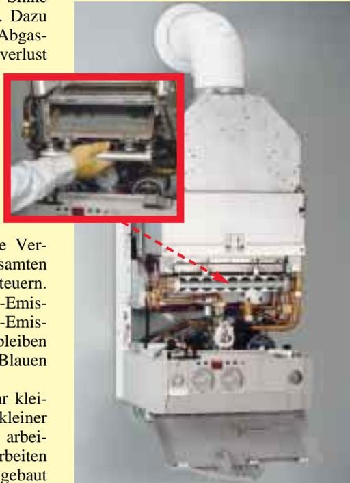
*Der atmosphärische „Thermostar“-Lamellenbrenner der neuen Gas-Kesselthermengeneration ist mit einer wartungsfreundlichen, herausnehmbaren Brennerwanne (Schnellverschlüsse) ausgestattet*
