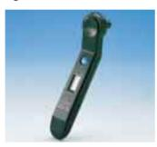
betriebnahme als auch bei der jährlichen vorgeschriebenen Wartung muß eine Überprüfung vorgenommen werden. Hier schafft ein elektronisches Vordruckmeßgerät von Zilmet Abhilfe.
