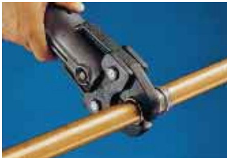
Zum innenverzinnnten Kupfersystem gehört die Preßverbindung
