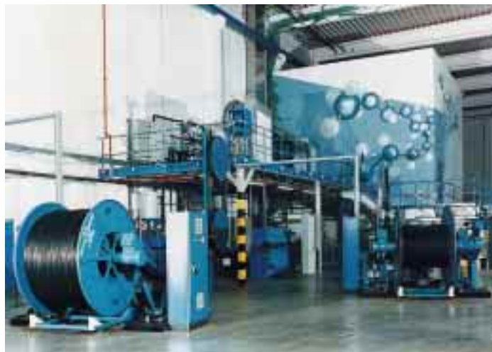
Eine Anlage zum Aufspüren von Undichtigkeiten in vernetzten PE-Rohren wurde in Zusammenarbeit von Hewing entwickelt
