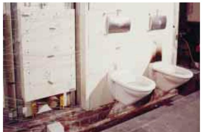
Die brandgeschützten Rapid-Installationselemente für Leichtbauständerwände wurden nach DIN 4102 in die Feuerwiderstandsklasse F 90 eingestuft
