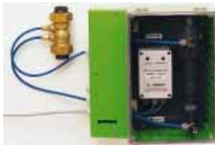
gerät Geno-control erlaubt die vollautomatische Überwachung des Weichwassers. Resthärten nach der Erhärtung werden über eine Anzeigeeinheit optisch angezeigt und als elektrisches Signal ausgegeben. Ein eingebauter Differenzdruckgeber ermöglicht die Systemrückführung des Prüf-/Meßwassers.
