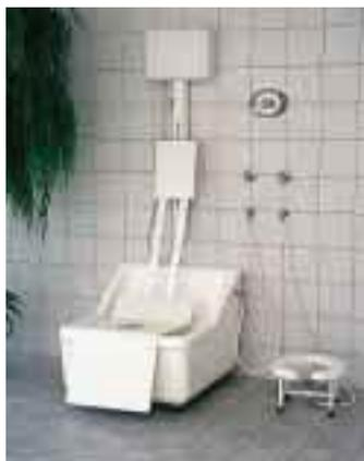
Der Lifter wird über eine elektrische Höhenverstellung durch Akkus betrieben und muß ca. 1 mal wöchentlich geladen werden. Die stromlose Luftsteuerung kann gefahrlos in das Wasser fallen und sorgt so für optimale Sicherheit. Der Lifter ist für Personen bis 150 kg geeignet. Die Montage erfolgt an der Wand über dem Sitzbad.
