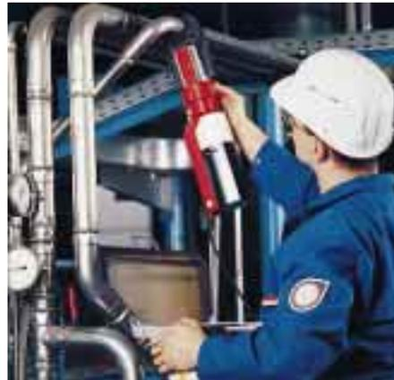
cherheit und Präzision. Es besitzt ein vollautomatisches Überwachungssystem (zeigt Fehler beim Verpressen, Überlastung etc. direkt an) und eine adaptive Steuerung des jeweils notwendigen Kraftverlaufs und läßt sich mit nur einer Hand bedienen.
