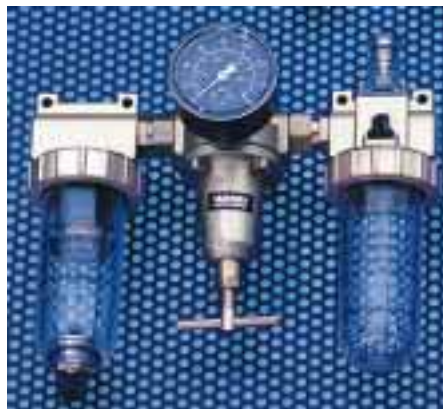
Wartungseinheit mit Kondensat- und Ölstandsanzeige (l.u.r.) sowie Arbeitsdruckregelung [6]
