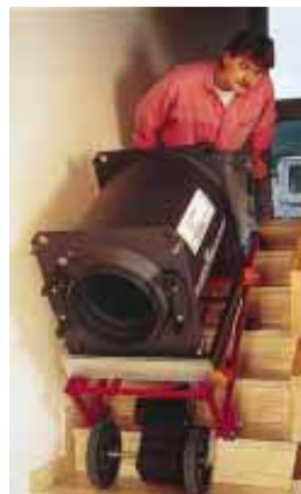
wobei bis zu 280 kg Last befördert werden können. Durch die höhenverstellbare Ladeschaufel kann man auch Lasten mit ungünstig liegendem Schwerpunkt transportieren. Zur sicheren Befestigung der Last ist das Gerät mit einem 35 mm breiten Gurt versehen. Für den Trans-
