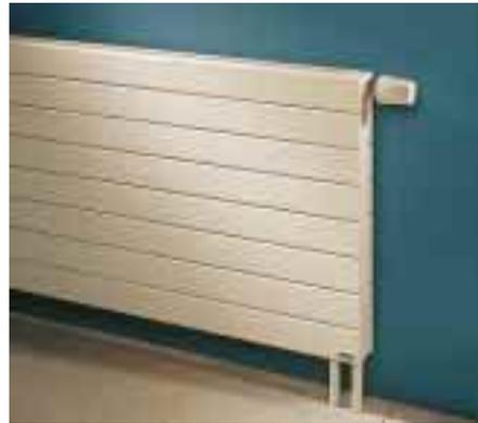
Die Ventilheizwand für Zweirohr-Systeme ist serienmäßig mit einer Ventilgarnitur ausgestattet, mit der die  $k_v$ -Werte voreingestellt werden können. Die Lotus-Ventilheizwand ist fertig vormontiert. Das Ventil ist auf diskret-elegante Weise oben rechts – ohne Thermostatkopf – eingebaut. Die Anschlüsse haben ein Innengewinde  $2 \times 1/2$ " rechts unten an der Heizwand.
