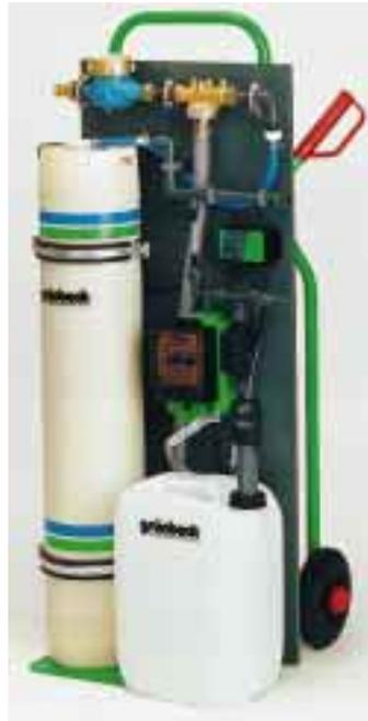
Die Rohrwasserentsalzungs- und Heizungsdosieranlage hat einen Nenndurchfluß von 900 l/h und eine Kapazität von 3900 l (bei 300 µS/cm im Rohwasser [ca. 10 °dH]). Die Anschlußnennweite beträgt am Eintritt R 1/2" und am Austritt R 3/4".
