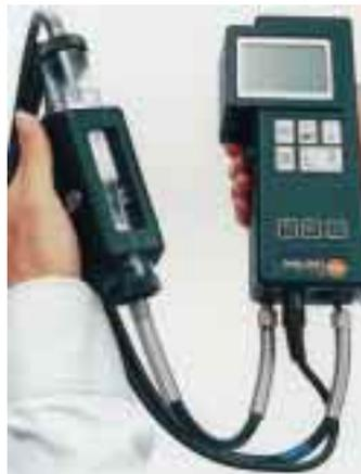
Meßgerät erhält „trockenes“ Meßgas. Dadurch ist eine hohe Sicherheit der Meßgeräte gewährleistet. Der verbesserte PESchmutzfilter und die nachgeschaltete Schmutzmembrane (Kondensatsperre) sorgen für zusätzliche Gerätesicherheit.
