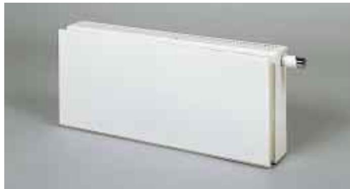
in Konvektionswärme um, die dem Raum zugeführt wird. Die Strahlungsverluste reduzieren sich dabei um ca. 80 %. Die Pulverbeschichtung des aus verzinktem Stahlblech gefertigten Strahlungsschirms erfolgt im Heizkörper-Farbtönen RAL 9010. Die neu konzipierte Montage-technik ermöglicht eine schnelle Montage am Heizkörper.
