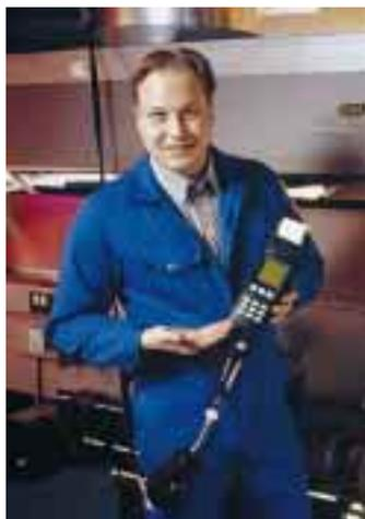
sätzlich einen erweiterbaren Speicher für die Meßwerte von 100 Anlagen. Außerdem ist die Messung von Kohlenmonoxid (CO)-Konzentrationen in der Umgebungsluft das Aufspüren von Lecks in der Gasleitung und die Differenztemperatur-Messung von Vor- und Rücklauf möglich.
