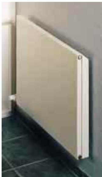
Form wird geprägt durch asymmetrische seitliche Schattenfugen, durch die sich eine Auflockerung der Seitenansicht ergibt. Durch die Form der von den Lamellen gebildeten Konvektorschächte ergibt sich eine Leistungssteigerung von rund 30 Prozent. Der Heizkörper kann in vier Bauhöhen, in Baulängen von 500–4500 mm und in allen RAL-bzw. Sanitärfarben, pulverlackiert, geliefert werden. Beim Modell Elegance II (unser
