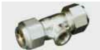
2440, 2441, 2442, 2448/1, 2458/1 im Trinkwasserbereich und Gasleitungen nach DIN 3387 als auch für Kunststoffrohre DIN 8075 PE und 8073 PE mit Klemmanschluß – beidseits Kunststoffrohr oder Kunststoff-/Stahlrohr – erhältlich. Die Verschraubungen sind jedoch auch für Brauchwasser, Benzin, Öl und andere Medien geeignet.
