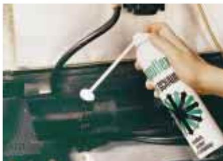
flex-Prüfschaum ermöglicht auch unter schwierigen Bedingungen eine zuverlässige Lecksuche. Mit dem DVGW-Prüfzeichen versehen, ermöglicht er das Finden und Darstellen von Leckstellen an allen Anlagen, die unter Druck stehen, besonders bei Kunststoff-Rohrleitungen, -Schläuchen, -Armaturen oder -Verschlüssen. Es kann bei
