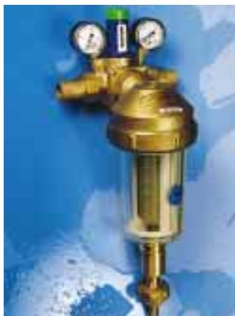
durch die bestehenden Einbaumaße verändert. So ist bei Bedarf die einfache, schnelle Nachrüstung eines permaster-Filters zur Hauswasserstation (ohne Rückflußverhinderer) möglich. Zur Ausstattung gehören außerdem ein Vor- und Hinterdruck-Manometer.
