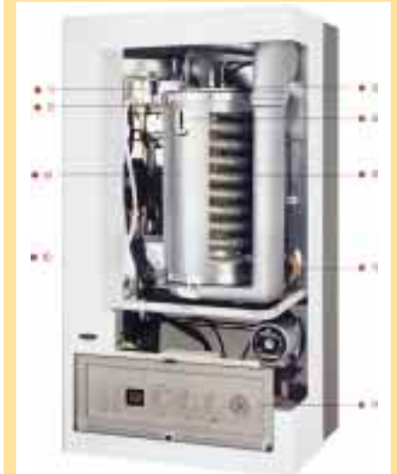
Brennwerttherme „TopCom“: (1) Ventilator (2) flachdichtende Verbindung der Gasstrecke (3) Bajonett-Verschluß für Brenner (4) Schauglas (5) Hochleistungswärmetauscher (6) Brennkammerschale (7) Wärmetauscher mit O-Ringdichtung und Sicherungsstift befestigt (8) Übergangszubehör für bestehende Anschlüsse (9) Regelung nach vorn abklappbar
