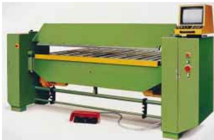
Alle Angaben wie z. B. Schenkellängen, Biegewinkel, Drehen, Wenden, Umschlagen, werden – wie manuell gezeichnet – am Bildschirm grafisch angezeigt und sind nach Bedarf änderbar. Gleichzeitig werden Ober-, Biege- und Unterwange maßstabgetreu dargestellt. Einige bedeutende Features dieser Neuentwicklung von Schechtel sind hochauflösende
