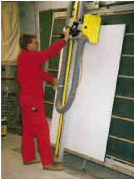
*Für den Zuschnitt der Trennwandplatten in der eigenen Werkstatt benötigt man einige Holzbearbeitungsmaschinen wie Plattensäge oder Tischfräse ...*
