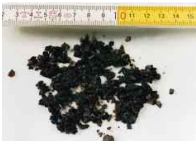
Bild 4 Filtrat der Wasserprobe aus Bild 1. Die körnige Struktur ist deutlich erkennbar
