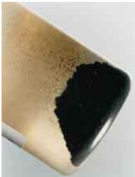
Bild 1 Diese Wasserprobe aus den reklamierten Anlagen zeigt die braun gefärbten, körnigen und losen Ausfällungen
