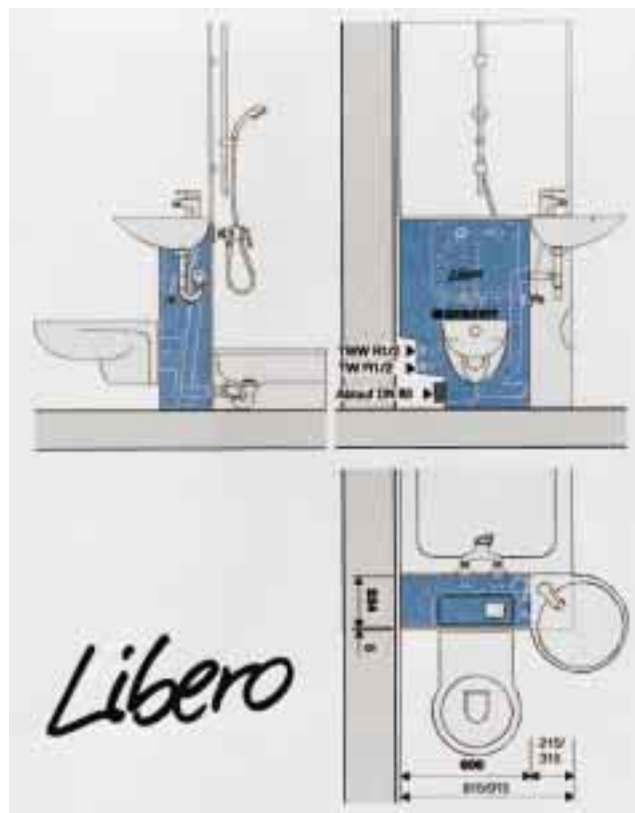
Die Varianten der Installationsmodule sind mit je einem Kalt-, Warm- und Abwasseranschluß in Links- und Rechtsausführung erhältlich
