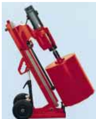
Kernbohrgerät WDS 350 für Löcher von 50 bis 350 mm
