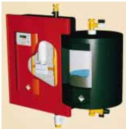
*Bestandteil der „Diamant“-Solaranlage ist das „Drain-Back“-System, bestehend aus Regeleinheit, Pumpengruppe und Rücklaufbehälter. Bei Anlagenstillstand schaltet das Kontrollsystem die Pumpe ab, und das Wasser aus dem gefährdeten Bereich (Kollektor, Verbindungsleitungen) fließt automatisch in den Rücklaufbehälter*
