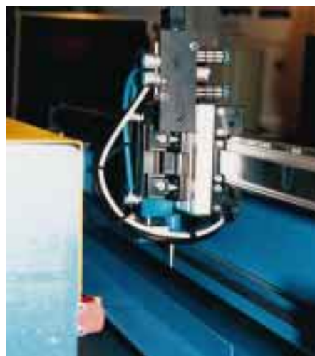
Forstner, Feldkirch, Österreich Kompakt zu einer Anlage sind Einzugsstisch, 6-Walzen-Richtmaschine, Mehrfachstreifenschere und Tafelschere vereint. Zusätzlich läßt sie sich mit automatischem Blechwechsel, Körnerstation (im Bild) sowie Stanz- und Sickenvorrichtungen ausrüsten
