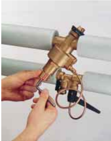
Bei dem Strangreguliertventil Ballorex von Broen wird der gewünschte Differenzdruck mit dem Sechskantschlüssel einreguliert
