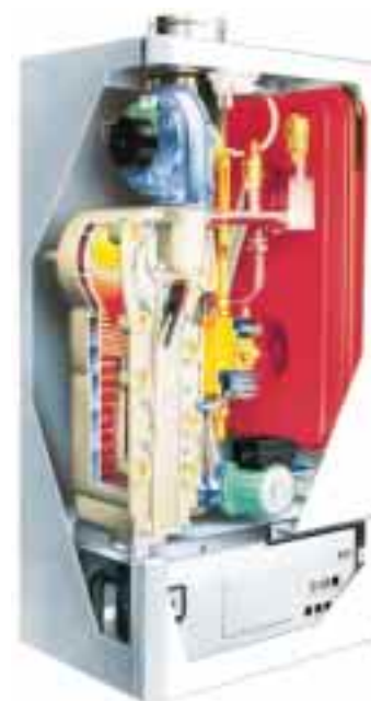
Modulierender Brennwertkessel „THR 5-25 M 75“ (5-25 kW) mit integriertem 75-l-Edelstahl-WW-Speicher (Geminox)
