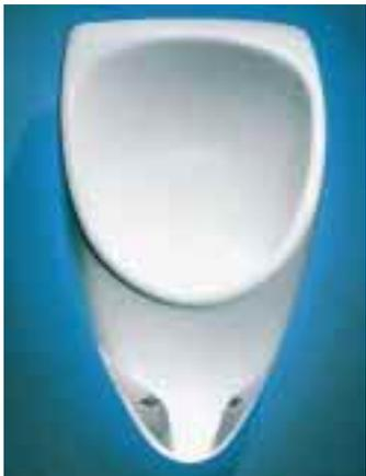
Flüssigkeit, die leichter als Wasser und Urin ist. Diese Sperrschicht läßt die Flüssigkeiten passieren und vermischt sich nicht. Aufsteigende Gerüche werden zurückgehalten. Herkömmliche Urinale können ge-
