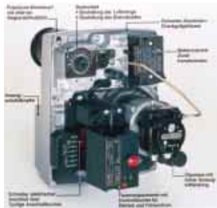
Beim Öl-Blaubrenner „Vectron Öko-Plus“ bewirkt ein Rezirkulations-Brennkopf, daß die zur Verdampfung des Öls notwendige Wärme durch Rückführung heißer Abgase gewonnen wird (Elco Klöckner)
