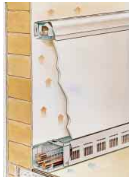
Bild 43 Beim „Hypoclima-Fertigplatten-system“ sind die Kupferrohrregister in eine mineralische Trägerschicht (Gesamtstärke 20 mm) eingebettet
