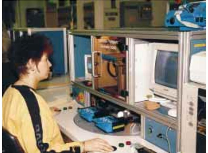
*Vor der Auslieferung wird die „Ecomatic 2000“-Regelung hier einer Funktionsprüfung unterzogen*
