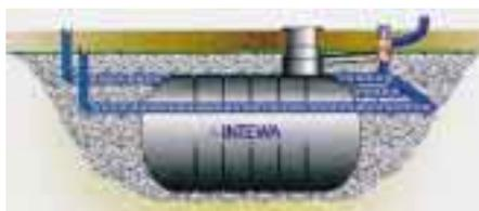
nutzt wird. Ist die Zisterne voll, wird mittels eines Überlaufs das überschüssige Wasser in die Sickerrohre geleitet, die es dann in der Kiesfüllung verteilen. Ein Anschluß an das öffentliche Kanalnetz entfällt komplett. Das „Ringsickerpaket“, das komplett mit Anschlüssen, Rohren und Abdeckflies geliefert wird, soll 998 DM kosten.
