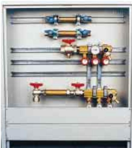
jeden Heizungsbauer eine unliebsame, da zeitraubende Angelegenheit. Nun hat Emcal das Problem „zur Strecke gebracht“ – mit der 130 mm bzw. 110 mm langen Einbaustrecke. Zur Installation der Zähler muß lediglich ein Messingrohrnippel zwischen zwei Kugelhähnen ausgeschraubt und das gewünschte Zubehörteil eingesetzt werden.
