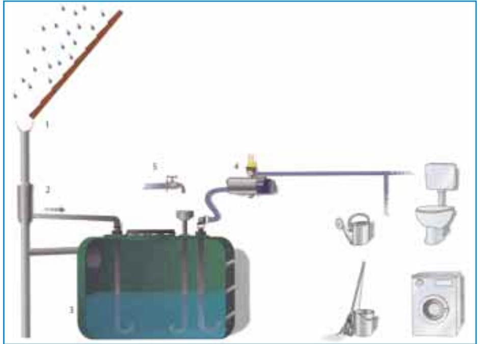
Das Regenwasser wird gesammelt (1), gefiltert (2), gespeichert (3) unter Leitungsdruk gesetzt (4) und in Trockenperioden durch Trinkwasser ersetzt (5)
