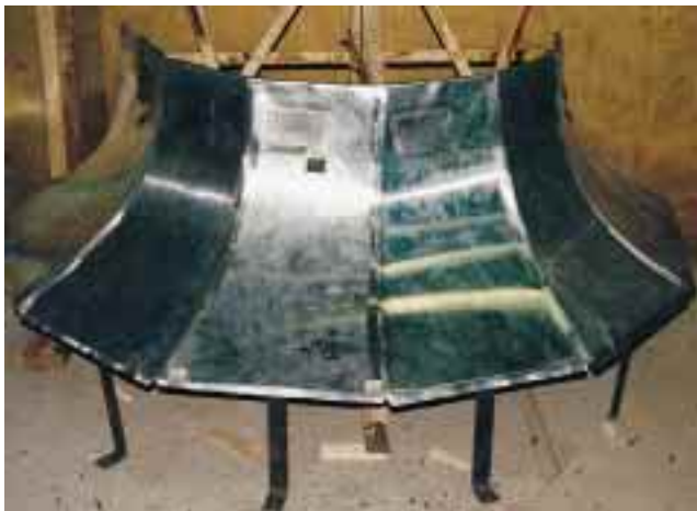
Die Krone wurde aus mehreren Teilen zusammengesetzt. Die unteren Teile bestehen aus zwei halben Zwölfecken [1]
