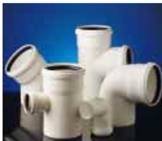
system seine Schalldämmeigenschaften. Dadurch können bisherige Wanddicken entsprechend der DIN 19 560 beibehalten werden und die Formstücke sind kompatibel zu den bisherigen HT- und KG-Programmen. Das neue Hausabflußsystem setzt sich aus einem umfangreichen Rohr-, Formteil- und Zubehörprogramm in den Nennweiten DN 50, 70 und 100 sowie Längen von 150 bis 3000 Millimeter zusammen.
