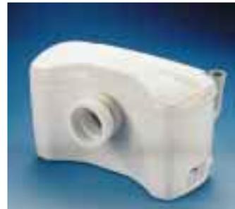
Das kleine Hebewerk drückt das Abwasser bis zu 6 Meter hoch. Integriert ist ein Aktivkohlefilter, der Gerüche absorbiert. Alle handelsüblichen WCs lassen sich mit der steckerfertigen Box nachrüsten. Für den Elektroanschluß genügt eine 220-Volt-Steckdose.
