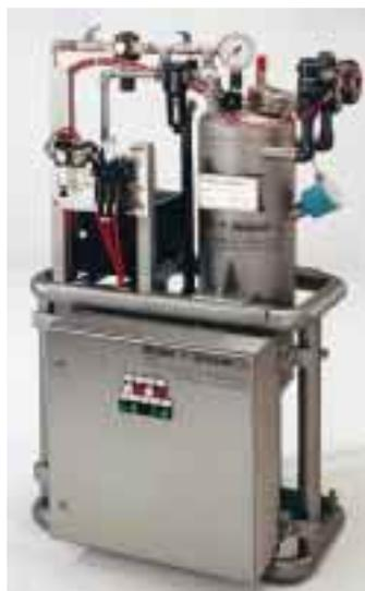
Kostenvorteil bei der Entsorgung. Das für Großküchen konzipierte System homogenisiert im Zwischenspeicher Biomasse, Schlamm und Fett und transportiert die Biomasse mit Druckluft in den Hauptspeicher. Hier werden organische Reststoffe und Speisereste zerkleinert und weiter homogenisiert. Der so gewonnene Wertstoff kann in der Biogasanlage als Reaktionsmittel zur Energie- und Methangasgewinnung genutzt werden.
