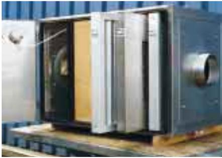
„Ultra Cleaner“ von Reven in Sersheim. Die fünf Filterstufen werden nach den vorkommenden Emissionen ausgesucht. Die kompakten Geräte haben ein Edelstahlgehäuse und sind für Volumenströme ab 800 m<sup>3</sup>/h verfügbar. Bei der reinen Ölnebelabscheidung ist die Filterstandzeit praktisch unbegrenzt; beim Feinstaubfilter – sofern hierzu Patronenfilter eingesetzt werden – beträgt die Standzeit mehrere Jahre.
