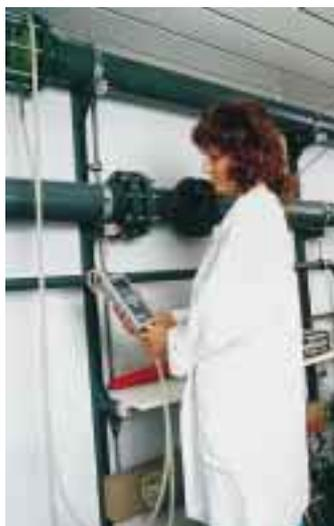
elektronisches Differenzdruck-Mikromanometer, dessen Piezo-Widerstandssensor den gemessenen Differenzdruck in ein elektrisches Signal umsetzt. Der Meßbereich beträgt -1000 bis 5000 Pa. Einsatz findet Climatest P 550 bei der zuverlässigen Bestimmung von Druckverlusten über Filter, Strömungswiderständen in Rohren und Kanälen sowie bei der Einstellung und Überprüfung von einzuhaltenden Druckunterschieden zwischen angrenzenden Räumen (Reinraumtechnik in Industrie und Krankenhäusern).
