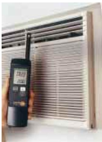
Anemometer in einer neuen Preisdimension sind bald auf dem Markt. Die Meßgeräte testo 415 und testo 425 haben ein zweizeiliges Display und zeitliche und punktuelle Mittelwertbildung.
