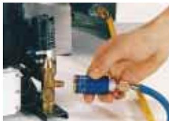
bleibt das Kältemittel durch das integrierte Absperrventil im Füllschlauch und entweicht nicht wie bisher üblich in die Umwelt.
