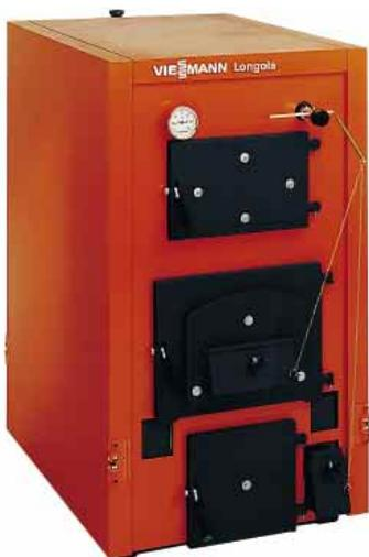
erfüllt diese Anforderungen. Er ist universell einsetzbar als Naturzugkessel bei ausreichendem Schornsteinzug oder als Kessel mit Saugzuggebläse (als Zubehör lieferbar) bei geringem oder witterungsbedingt schwankendem Schornsteinzug. Der Kessel ist rundum wassergekühlt. Bis zu 50 cm lange Holzstücke können verbrannt werden.
