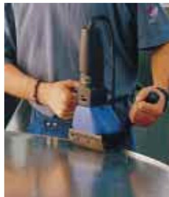
oder gekrümmten Kanalstücken mit Außenradien von R 300 mm. Einstellarbeiten an Blechdicke und Falzhöhe sind nicht erforderlich. Durch Eigenvorschub entsteht eine Schließgeschwindigkeit von bis zu sechs Metern pro Minute.
