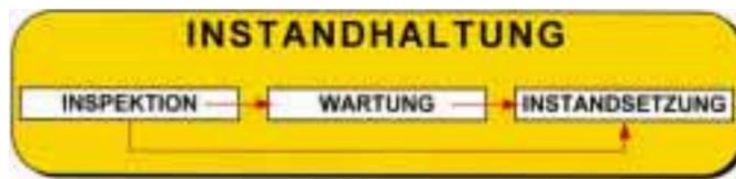
Die Bedeutung der Begriffe zur Instandhaltung von sanitärtechnischen Einrichtungen ist in DIN 31 051 genormt
