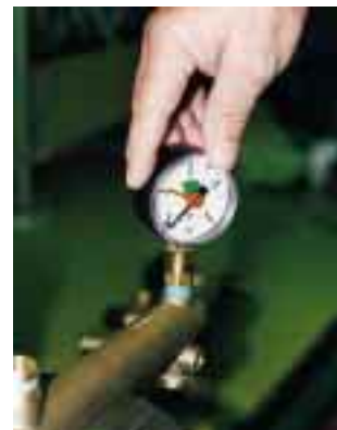
Montage eines Manometers im Herstellerwerk
