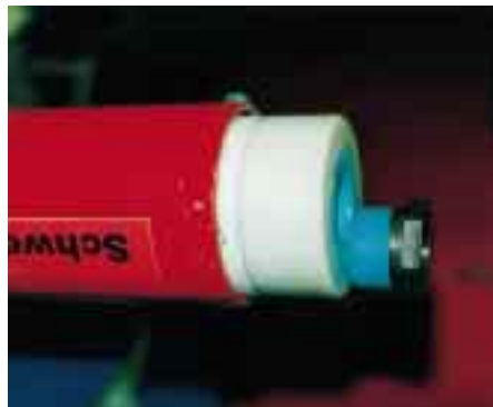
Beschichtet wird der Fitting, indem man ihn in die Bohrung drückt und gleichzeitig dreht
