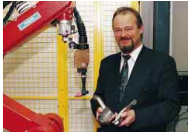
Hansgrohe-Chefingenieur Dieter Kratzer zeigt die zwei 1,5 mm starken Armaturenhälften aus Edelstahl
