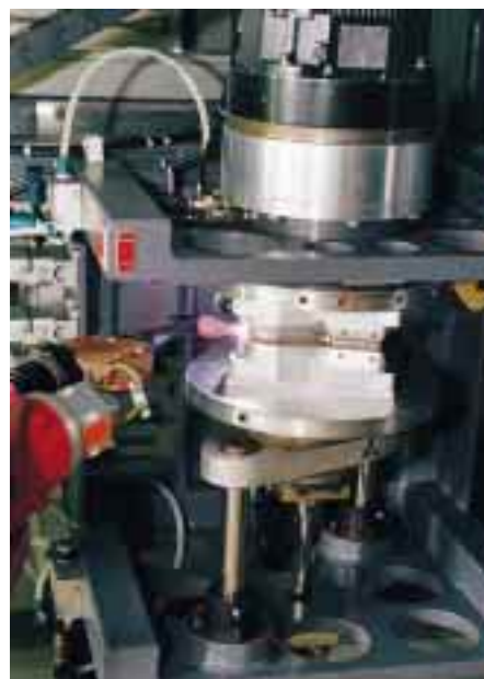
. . . und die zwei Hälften – ohne Materialzugabe – mittels Plasmaschweißung zusammengesetzt
