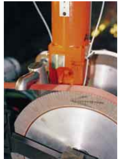
Es folgt der vollautomatisierte Schleifvorgang und das Ausschneiden der oberen Öffnung. Die abschließende Montage der Mischtechnik erfolgt wie bisher
